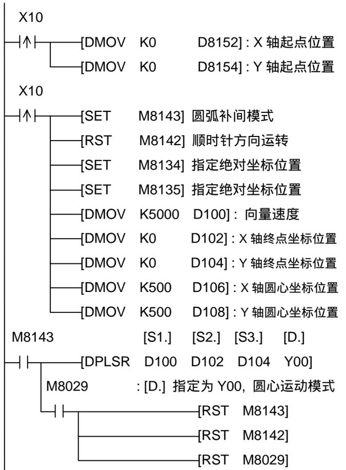
(II) 输入终点绝对坐标、圆心坐标 逆时针 CCW 方向 (G03)
