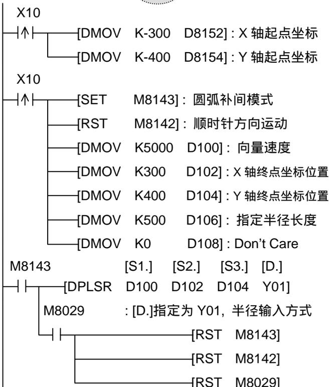
(IV) 输入终点绝对坐标、半径(r)长度, 逆时针方向, 若 r 为正值, 则为小圆路径。若 r 为负值, 则为大圆路径。
